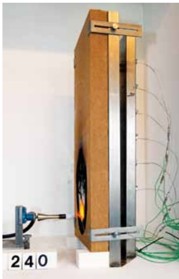
Abb. 5: Prüfung zum Brandverhalten von Bauprodukten – Bestimmung der Neigung eines Bauprodukts zum kontinuierlichen Schwelen nach EN 16733:2016.
