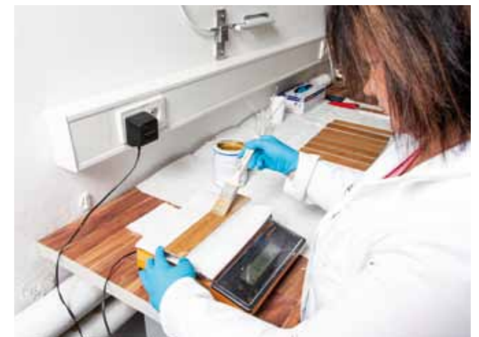
Abb. 10: Vorbereitung eines Prüfkörpers zur Prüfung der Emission von flüchtigen organischen Verbindungen (VOC) aus einem Oberflächenbeschichtungsmittel
