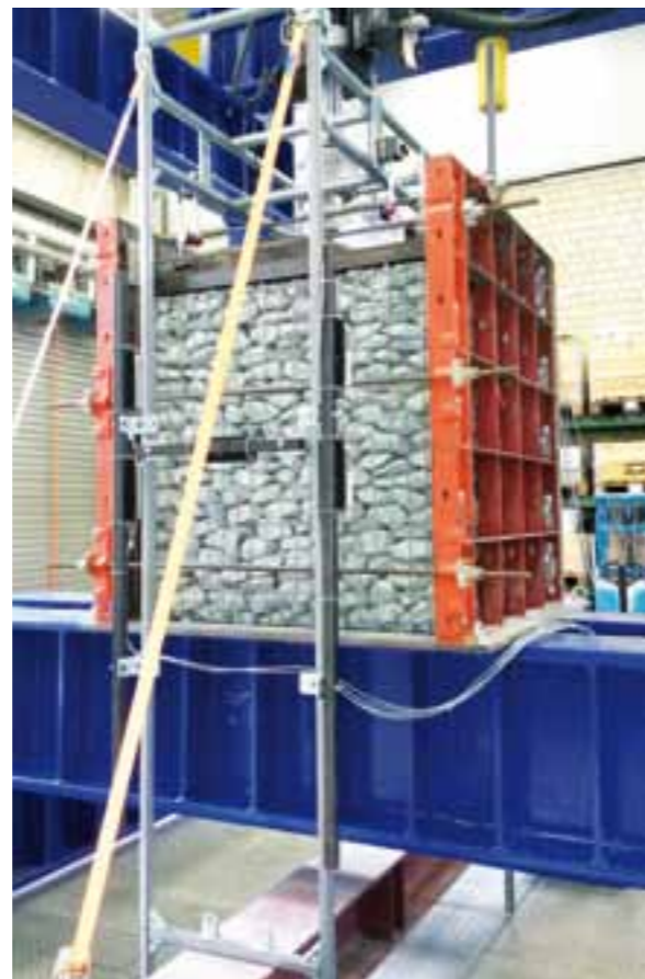
Abb. 5: Prüfung der inneren Standsicherheit einer Gabione durch vertikale Belastung
